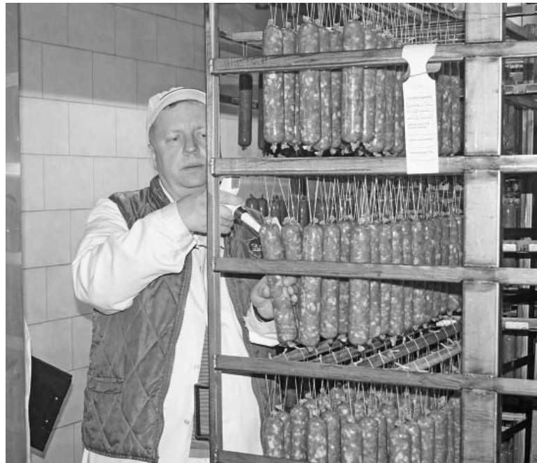
Измерение водородного показателя (рН) колбасы.
